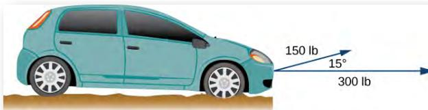
**Figura 2.21.** Dos fuerzas que actúan sobre un automóvil en diferentes direcciones.
