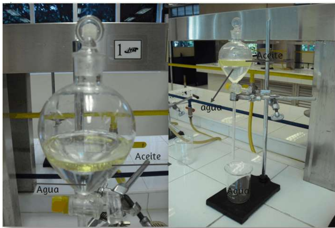
Figura 3.22. Embudo de decantación, separación de agua y aceite, dos líquidos no miscibles (crédito: Patiño J. Margarita. Valdes R. Nilkar. Química Básica. Prácticas de laboratorio)
