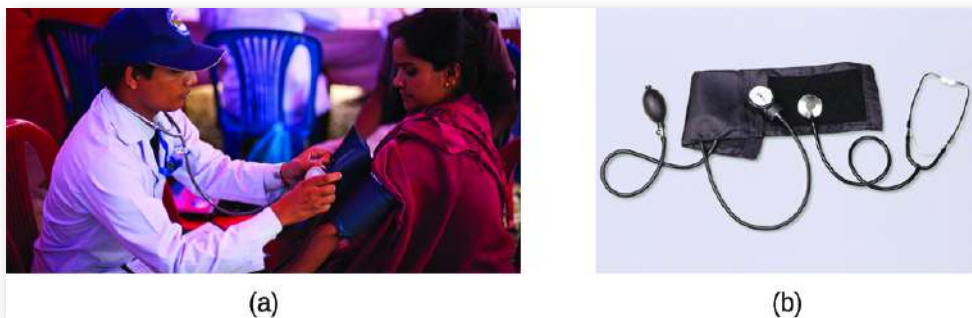
Figura 8.6 (a) Un técnico médico se prepara para medir la presión arterial de un paciente con un esfigmomanómetro. (b) Un esfigmomanómetro típico utiliza un bulbo de goma con válvula para inflar el manguito y un medidor de diafragma para medir la presión (crédito a: modificación del trabajo del Sargento Primero Jeffrey Allen).
