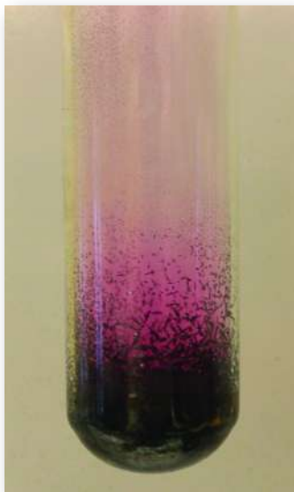
Figura 9.27. La sublimación de yodo sólido en el fondo del tubo produce un gas púrpura que posteriormente se deposita como yodo sólido en la parte más fría del tubo de arriba. (crédito: modificación del trabajo de Mark Ott)
