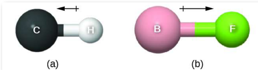
Figura 7.26 Hay una pequeña diferencia en la electronegatividad entre C y H, representada como un vector corto. (b) La diferencia de electronegatividad entre B y F es mucho mayor, por lo que el vector que representa el momento del enlace es mucho más largo.
