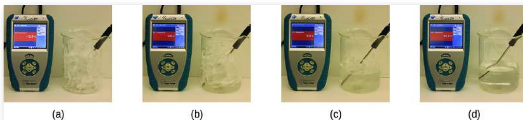
Figura 9.26. (a) Este vaso de hielo tiene una temperatura de -12.0^{\circ}\text{C} . (b) Después de 10 minutos, el hielo ha absorbido suficiente calor del aire para calentarse a 0^{\circ}\text{C} . Una pequeña cantidad se ha derretido. (c) Treinta minutos después, el hielo ha absorbido más calor, pero su temperatura aún es de 0^{\circ}\text{C} . El hielo se derrite sin cambiar su temperatura. (d) Solo después de que todo el hielo se haya derretido, el calor absorbido hace que la temperatura aumente a 22.2^{\circ}\text{C} . (crédito: modificación del trabajo de Mark Ott)
