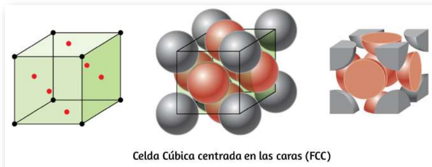
Figura 9.52. Un sólido cúbico centrado en la cara tiene átomos en las esquinas y, como su nombre lo indica, en los centros de las caras de sus celdas unitarias.
